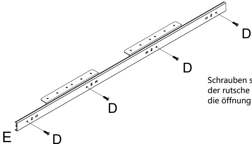
Schrauben sie die Löcher an den beiden Enden der Rutsche an. Sie werden dann gezogen und die Öffnung in der Mitte wird mit Bolzen fixiert.
